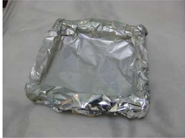
圖六 巴沙木條製成的燃料槽骨幹，底部卡榫可穩固安放在 X 形巴沙木條上（左）。鋁箔包覆巴沙木骨幹，形成以巴沙木為骨幹的鋁箔燃料槽。
